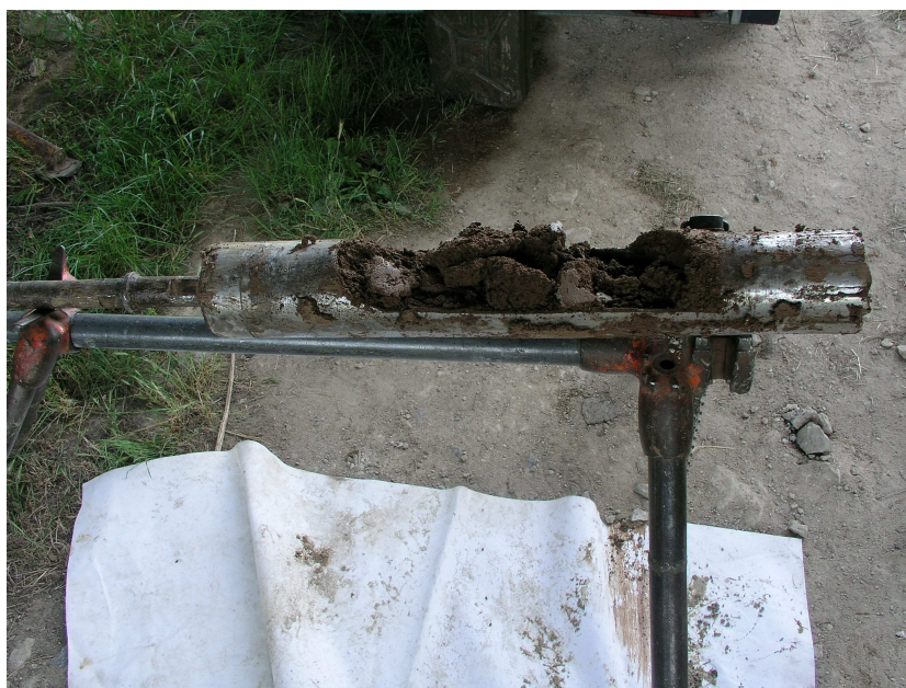
Vrt Pvs 1, jádrovka s tvrdokovovou korunkou
